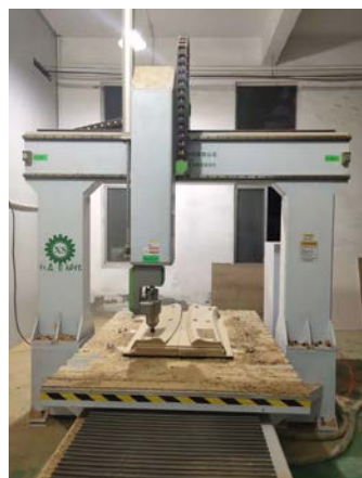
(木工、卫浴、碳纤维等，五轴联动加工，一次性雕刻成型)
