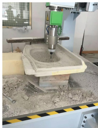
(木工、卫浴、碳纤维等，五轴联动加工，一次性雕刻成型)
