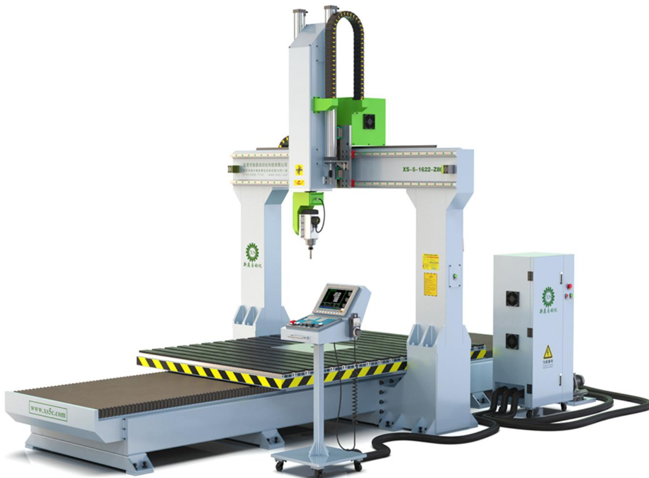
上图为五轴龙门加工中心，是集运动力学、电机电气、丝杠导轨等技术一体化设计；人机界面操作，工序为图纸、建模、编程、雕铣、切割、异型加工等，可一次性完成吸塑成型后需要加工的数道常规或者异形工序；
