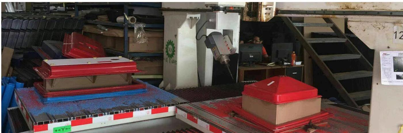
(厚板吸塑，五轴联动加工，一次性成型)
